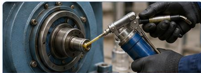
Inspección y aplicación de lubricantes en equipos rotatorios
